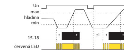
Pro zamezení polarizace a elektrolýzy kapaliny a nežádoucí oxidaci měřicích sond je k měření použito střídavého proudu. K měření je využito tří měřicích sond: H - horní hladina, D - spodní hladina a C - společná sonda. V případě použití nádrže z vodivého materiálu je možné jako sonda C využít vlastní nádrž.
