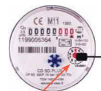
Rotující indikátor vodoměru Infra Red senzor IRS
