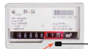
Zabudovaný magnet v plynoměru Magnetický senzor MS
